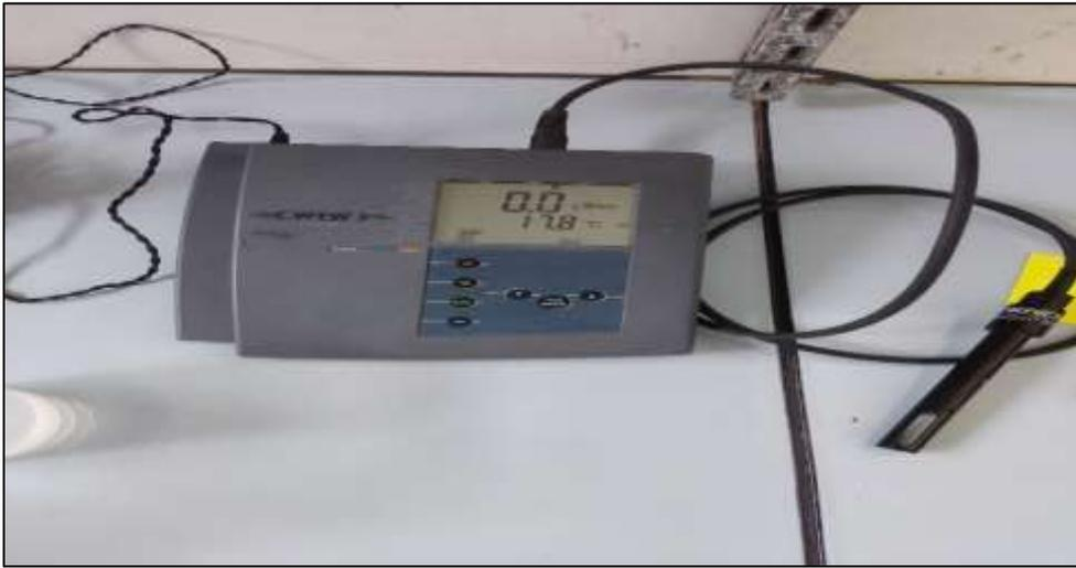
الشكل 23: جهاز قياس الناقلية Electro Conductivité mètre (تصوير الباحث)
